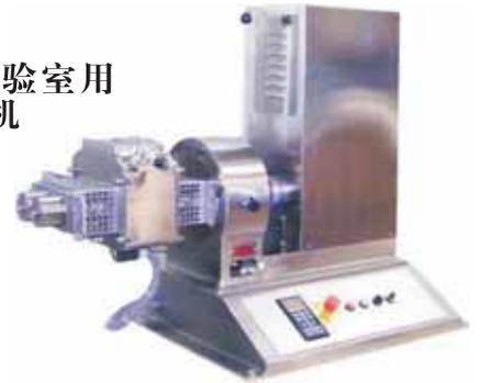
如有需要，例如在必需符合美国FDA食品药物卫生条例之下，除了捏合浆、缸体和缸底等与混合物料的部位使用不锈钢外，其它与混合物料无直接接触的设备部位，亦可使用不锈钢，例如支架、齿轮箱、马达减速机和驱动架等。不锈钢表面打磨抛光，不使用喷漆。这种全不锈钢设计，特别适用于医药用口香糖的生产加工，例如含尼古丁的口香糖。
